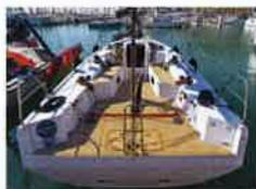
Länge ü. a. 10,70 m, Breite 3,60 m, Tiefgang 2,18 m, Gewicht 4,9 t, Segelfläche 71,0 m<sup>2</sup>, Grundpreis ab Werft 165 410 Euro, Test in YACHT 23/2017
