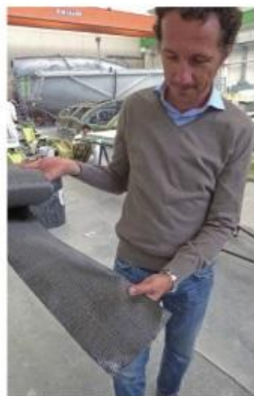
Fabio Planamente, director general del astillero, muestra una pieza de tejido de fibra de carbono con la que se realizan varias partes de los veleros y el T top de las motoras.
