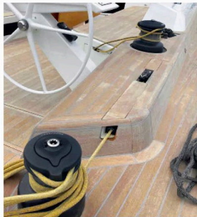
Übersichtlich und aufgeräumt. Alle Schoten sind so weit wie möglich unter Deck geführt
