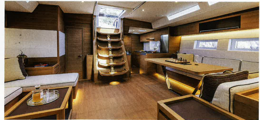
Salon: Den Raum dominiert Teakfurnier, das im Sandwich auf Schaumkernen liegt. Durch die Pantry geht es in die Crew-Kabine mit Stockbett
