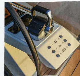
Die Steuersäule vereint die Bedienung von Motor, Bugstrahler und der Segelsysteme
