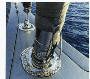
Genua und Code Zero haben Rollrefanlagen, das Auge auf dem Bugspriet hält den Gennaker
