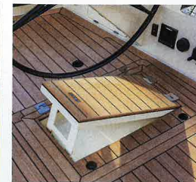
Der Rudergänger sitzt auf dem Süllausläufer oder steht bei Krängung auf der Stufe
