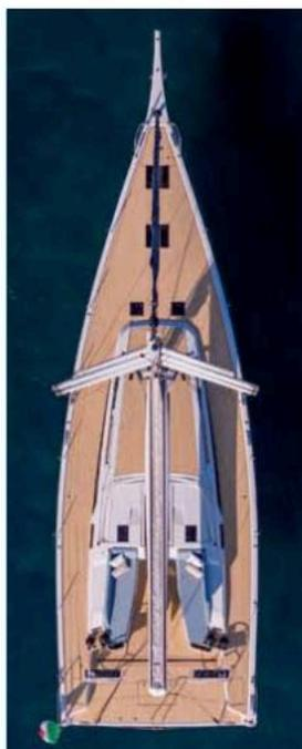
La Performance prevede un piano di coperta "easy sailing" con 4 winch a poppa, scotta randa con punto fisso, fiocco autovirante standard e bompresso in carbonio standard; il pozzetto è libero dalle manovre per essere fruibile dagli ospiti in sicurezza.
