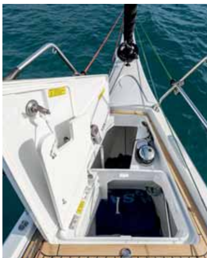
V přídi je nejen schránka na kotevní řetěz, ale také úložný prostor pro lana, fendry a další materiál.
