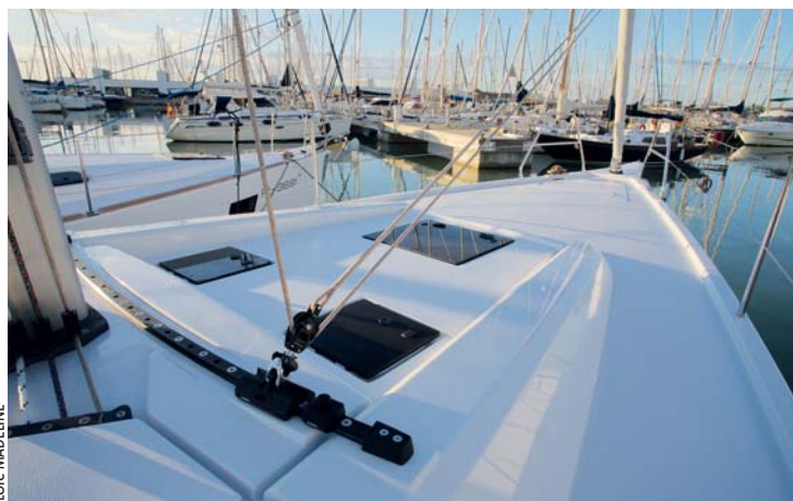
Autovireur. Le rail courbe du foc autovireur est posé sur le rouf. Ce dernier peut accueillir un matelas double pour lézarder au mouillage.
