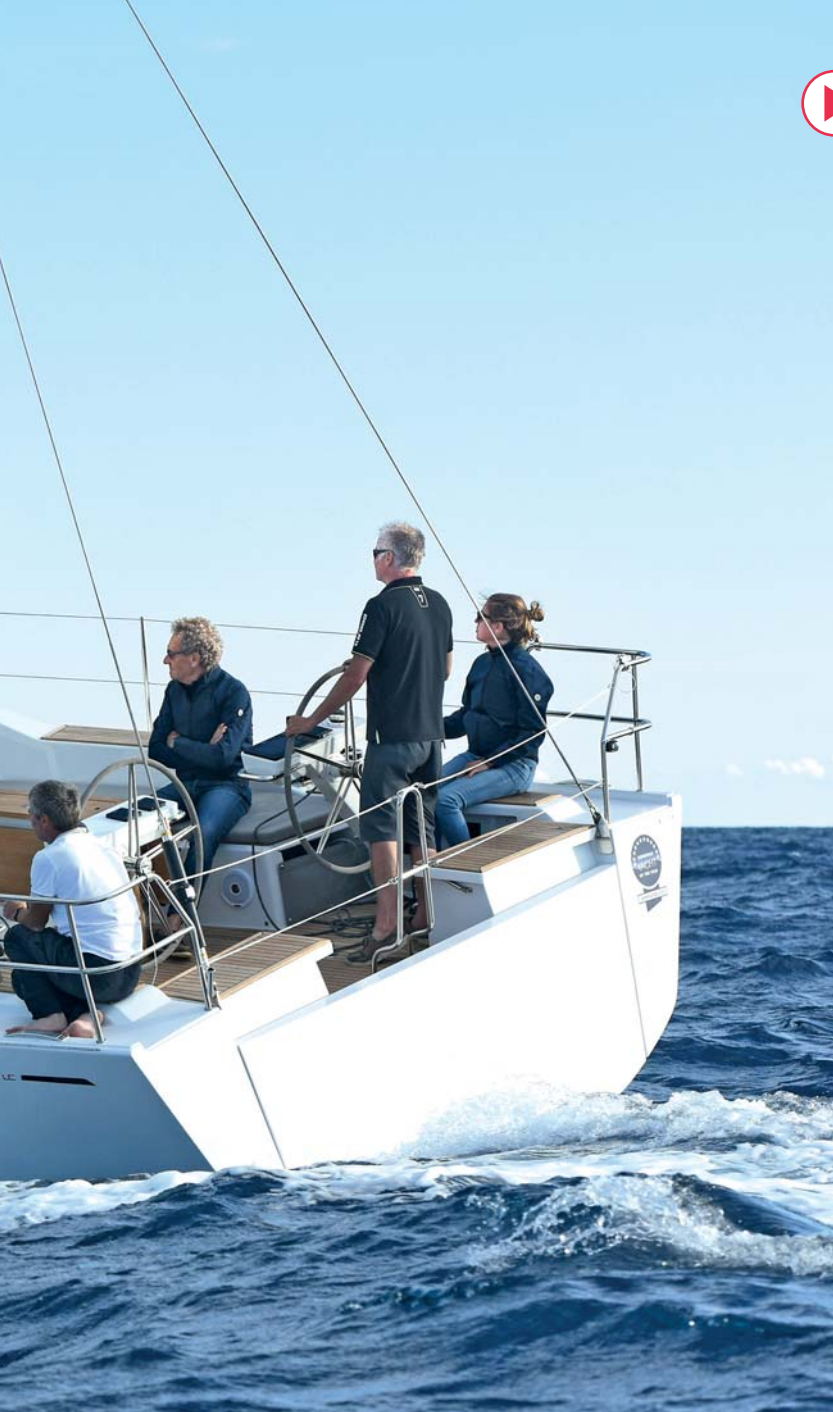
Joliment toilé. Les deux voiles sont montées sur enrouleur mais bénéficient de lattes verticales pour tenir leur chute. L'arceau souligne la vocation «croisière».
